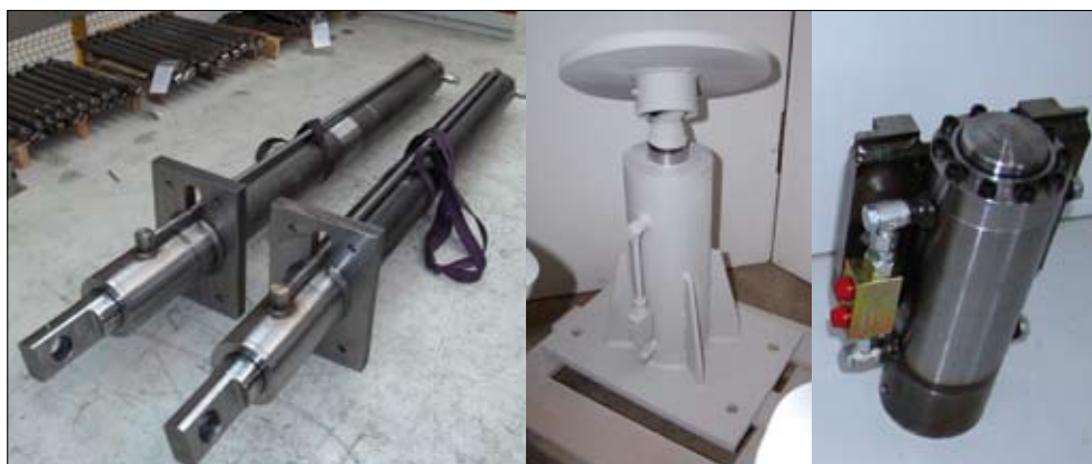
La produzione DE.OL. è molto ampia. La sua attività prevede, tra le altre cose, anche la realizzazione di cilindri oleodinamici per trivelle e per macchine compattatrici destinate al settore dei rifiuti
